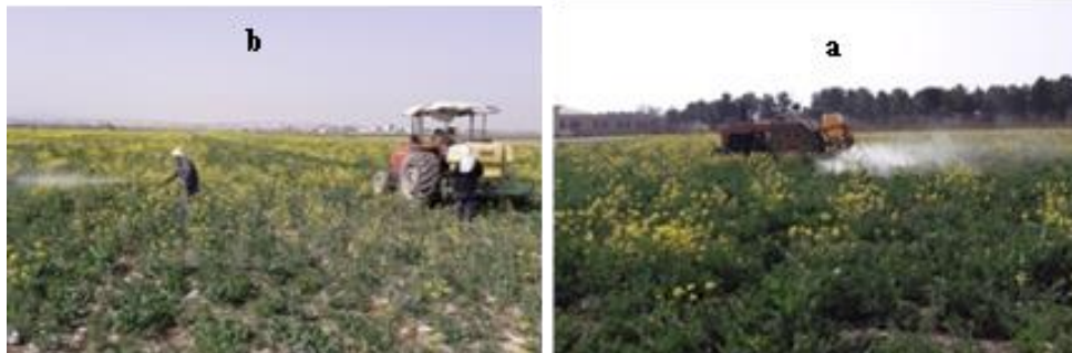
شکل ۱- سمپاش بوم‌دار پشت‌تراکتوری (a) و سمپاش لانس‌دار پشت‌تراکتوری (b)
